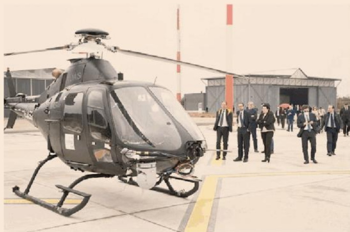
AWSolo. L'elicottero privo di pilota del progetto Urano di Leonardo-Telespazio
